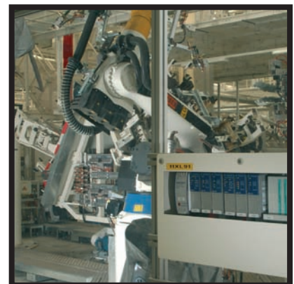
Die Verteiler werden direkt in den Produktionszellen integriert.
